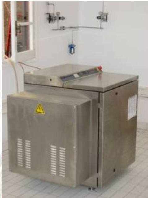
PEM electrolyser Hogen RE
